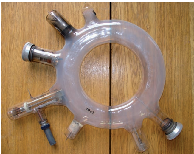
Zkušební komora betatronu z Ústavu fyziky plazmatu ČSAV. Od největšího „výstupku“ po směru hodinových ručiček: elektronová tryska, sonda měření svazku, vakuová měřka, čerpání, terčik, sonda, sonda (foto M. Řípa)
